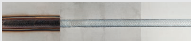
/ CrNi przed oczyszczeniem
